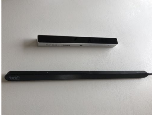
FIGURE 2 – Deux des oculomètres qui permettent de jouer avec GazePlay : l'Eye Tribe en haut, le Tobii 4C en bas.
